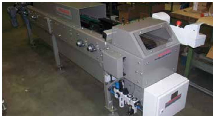
Werkstückträgerband mit aufstauender Wirkung
