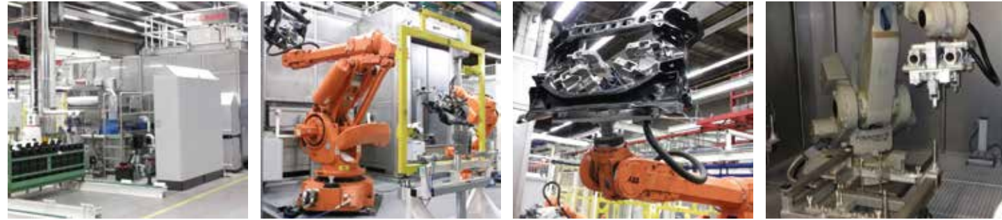
Roboterbasierte Reinigungsanlage für Fahrwerkträger
