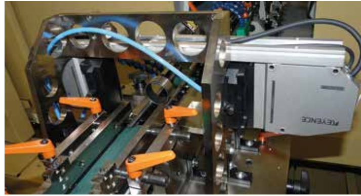
Auslaufband mit optischer Messeinrichtung
