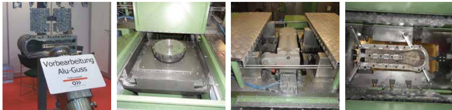
Vorräsmaschinen für Aluminium-Druckgussteile
