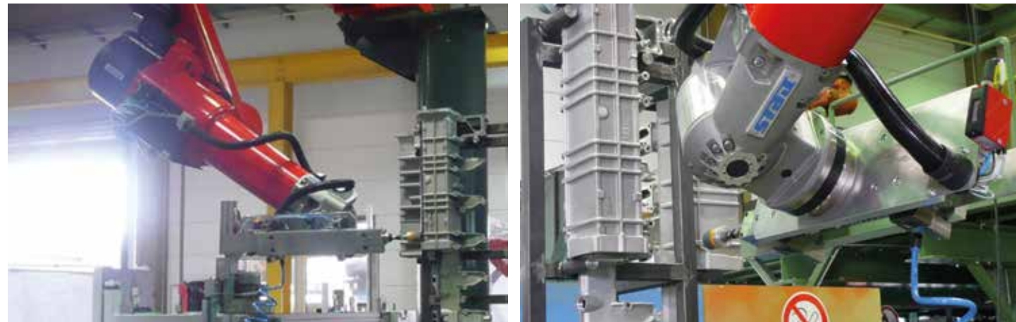
Roboterhandlung zum Handhaben eines Druckguss-Bauteils in mehreren Werkzeugmaschinen inkl. Bürsten
