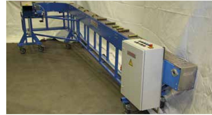
Ofenzuführband mit Steuerung
