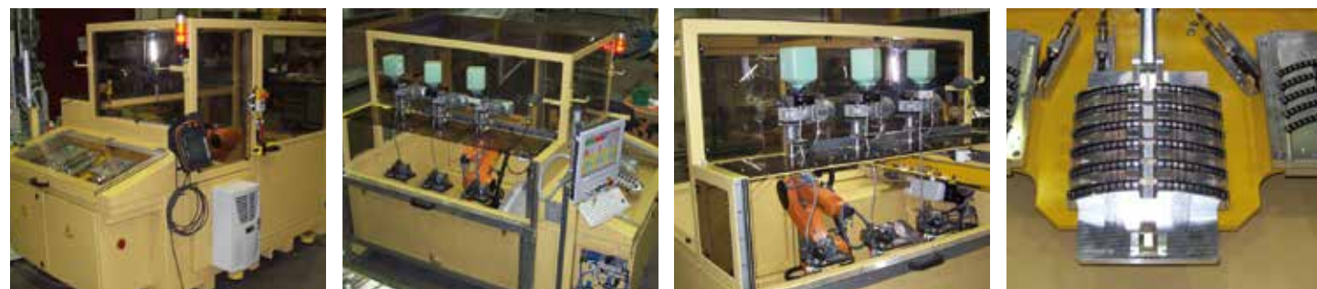
Roboterbasierte Montageanlage für Wälzkörper in Kugellagerkäfige
