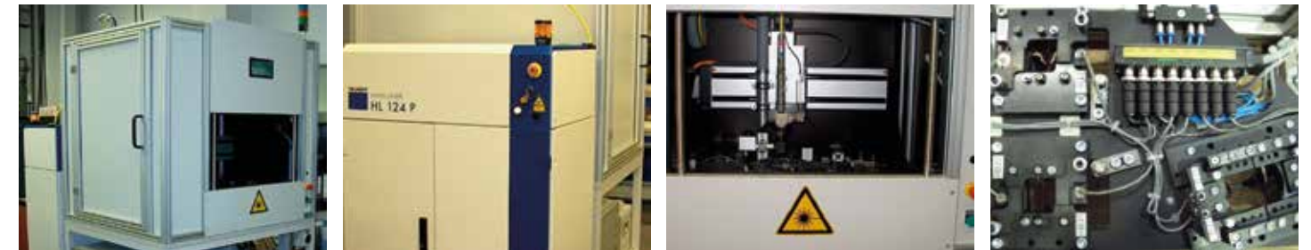
Laserschweißanlage mit Fügevorrichtung für Leitergitter in automatischen Pkw-Getrieben
