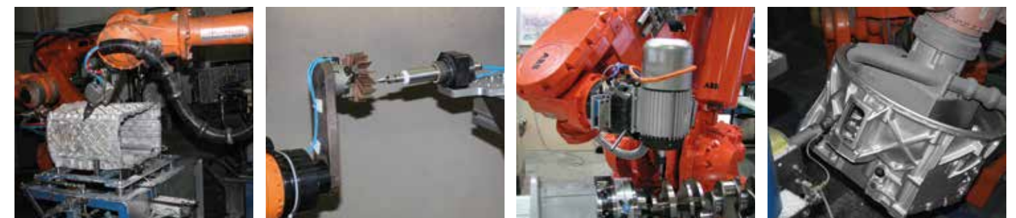
Roboterbasiertes Gussputzen von Aluminium-Druckguss-Bauteilen
