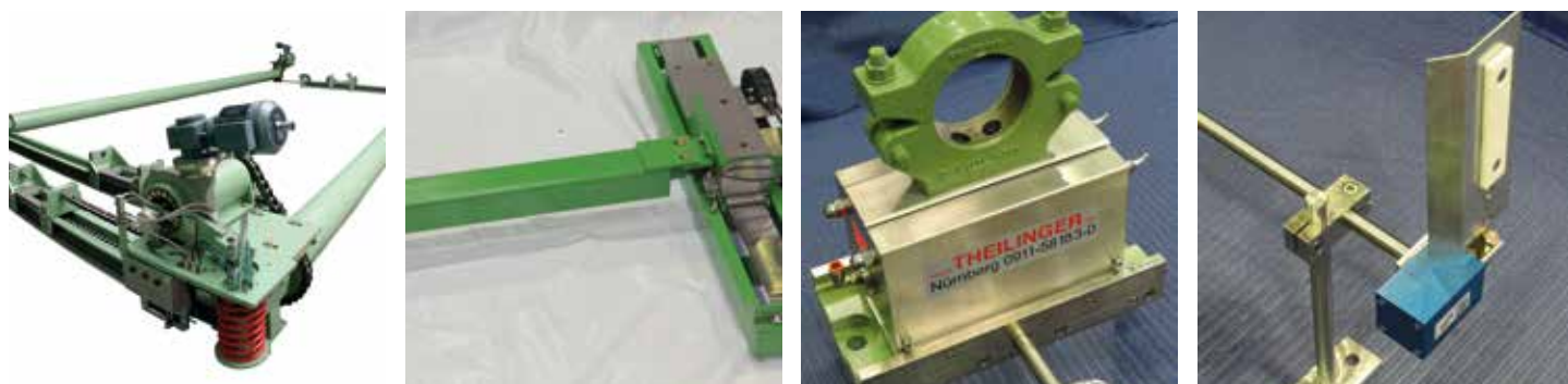
Elektr. angetriebener Siebspanner mit Kraftmessung und Kette
