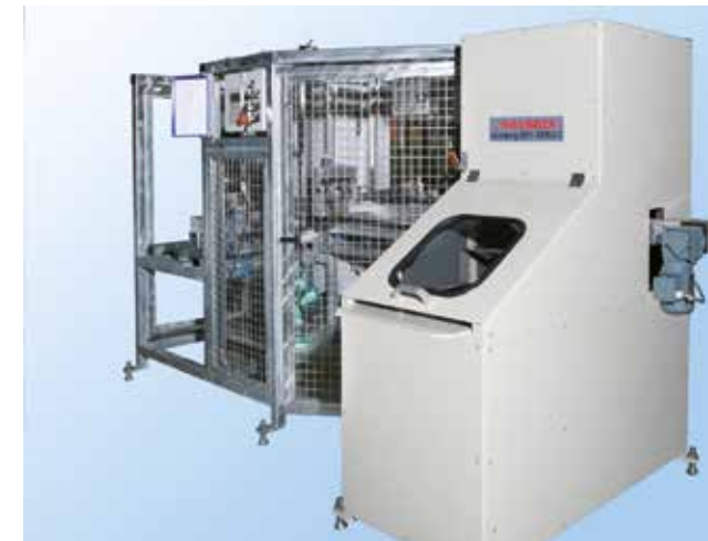
Schiebeförderer für alle länglichen Werkstücke
