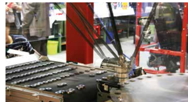
Erkennung der Bauteile inkl. Ober-/Unterseite
