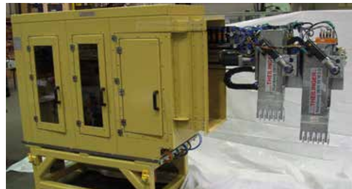
Ladeportal 12-fach mit Explosionsschutz
