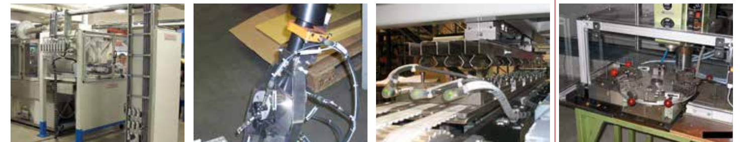
Federzuführung mit 3x7 Gruppierung mit 21-fach-Greifer
