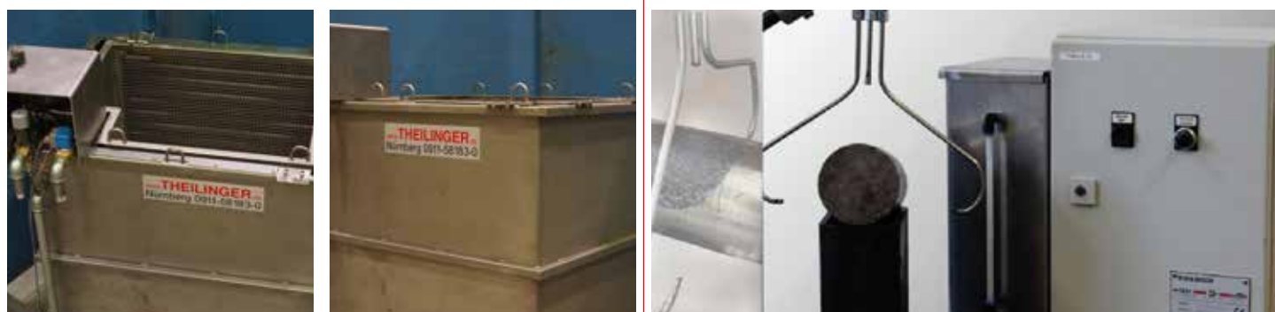
Tauchkühlbecken für Aludruckguss/Erzeugung – besonders energieeffizient
