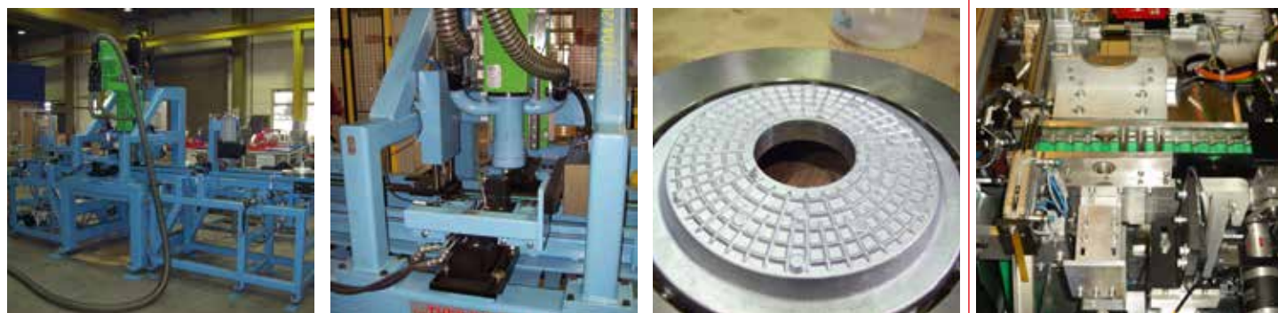
Automatische Bohranlage für Bremsscheiben
