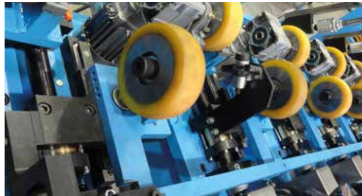
Auslaufband mit optischer Messeinrichtung
