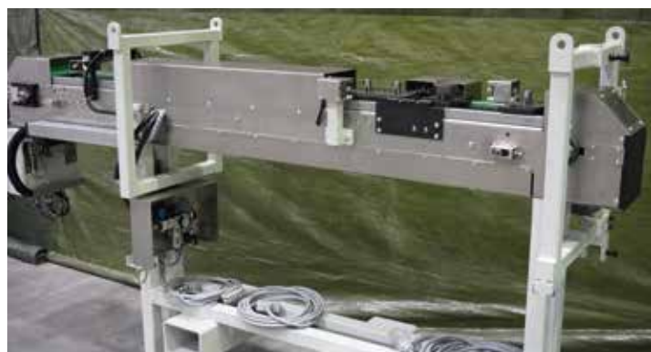
Werkstückträgerband für Einlegeteile
