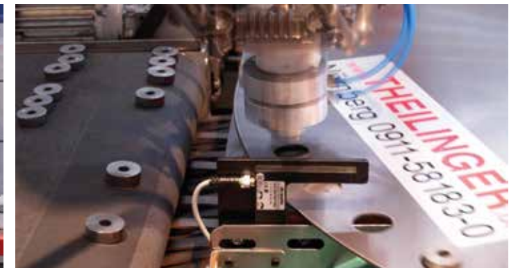
Passgenaues Greifen und Einlegen in Transportscheibe einer Schleifmaschine
