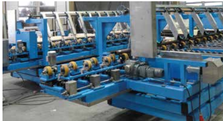
Stangen Zu- und Abführung mit Rotationsantrieb und Pufferspeicher
