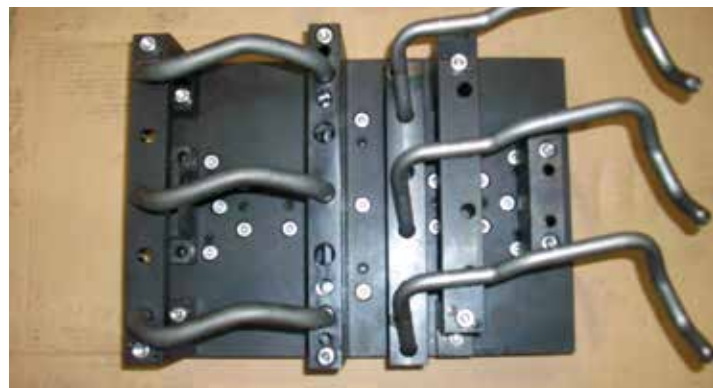
Werkstückträger mit Rohrbiegeteilen für Robotermontage
