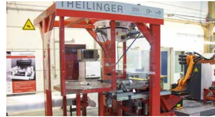
Multifeeder zum schnellen, lagerichtigen Einlegen von Werkstücken; bis 150 Stk./min.
